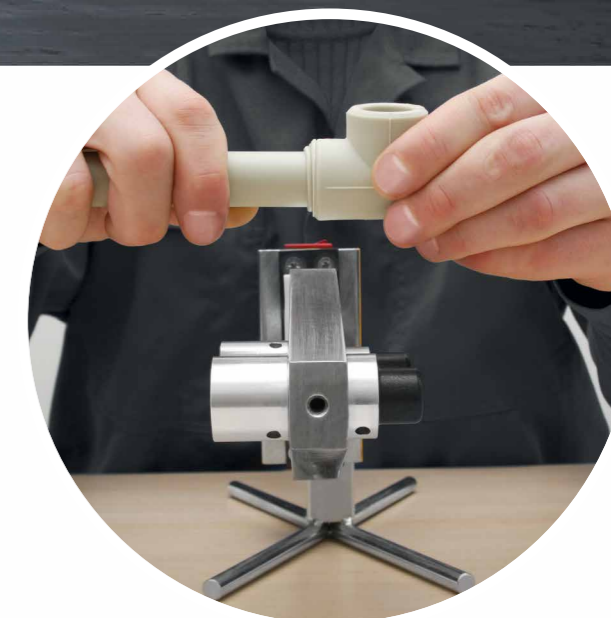
06 Фиксация и охлаждение соединения.
