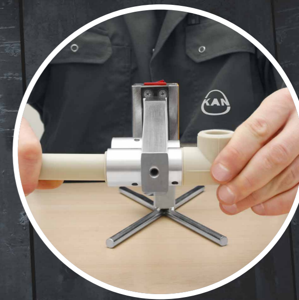
04 Нагрев трубы и соединителя.
