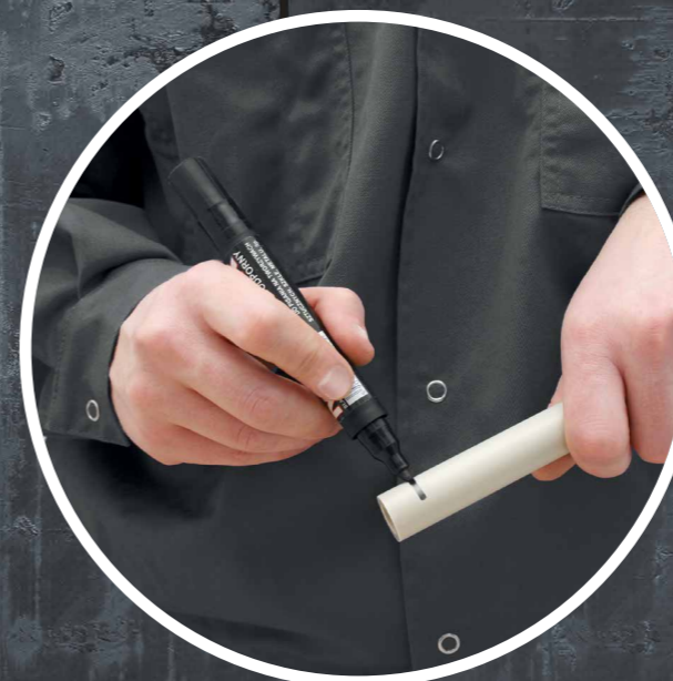
03 Обозначение глубины сварки.
