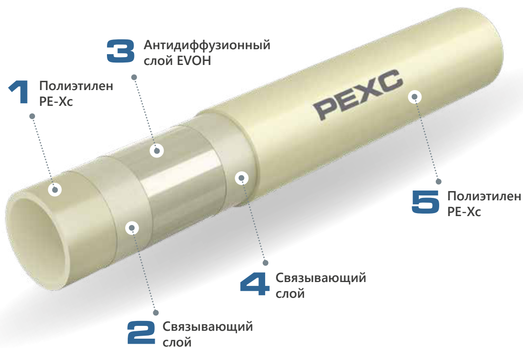
Рис. 48. Конструкция труб PEXC со слоем EVOH.
