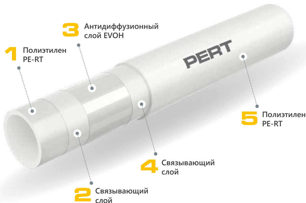
Конструкция трубы PERT со слоем EVOH
