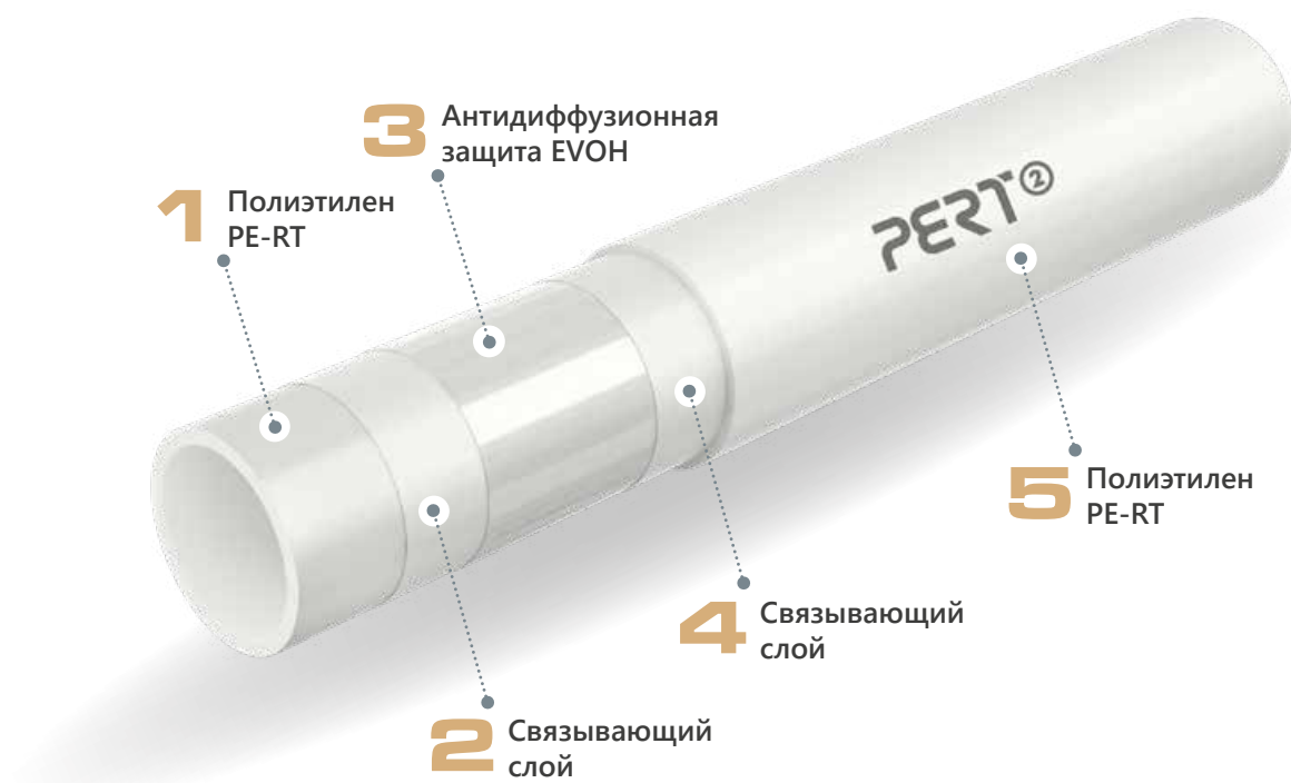
Конструкция трубы PERT 2 с антидиффузионным слоем
