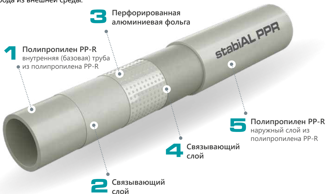
Конструкция комбинированной трубы stabiAL PPR
