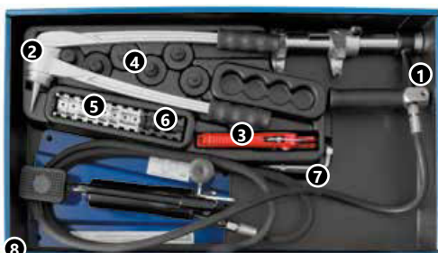
Комплект в чемодане - пресс гидравлический с ножным приводом
