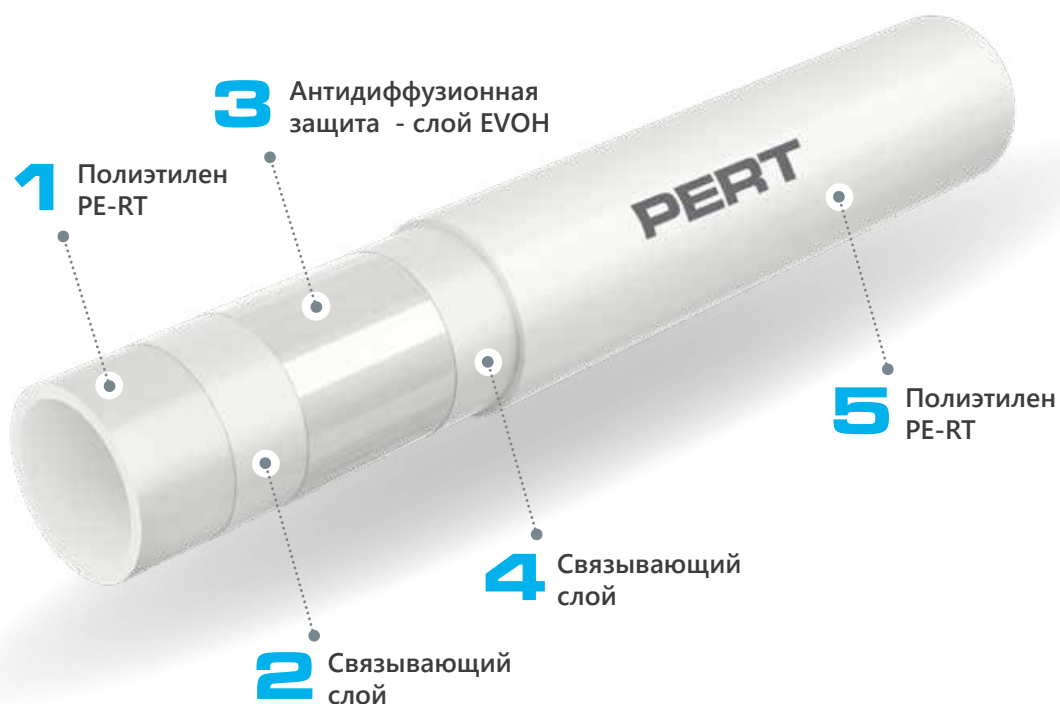
Конструкция трубы PERT со слоем EVOH
