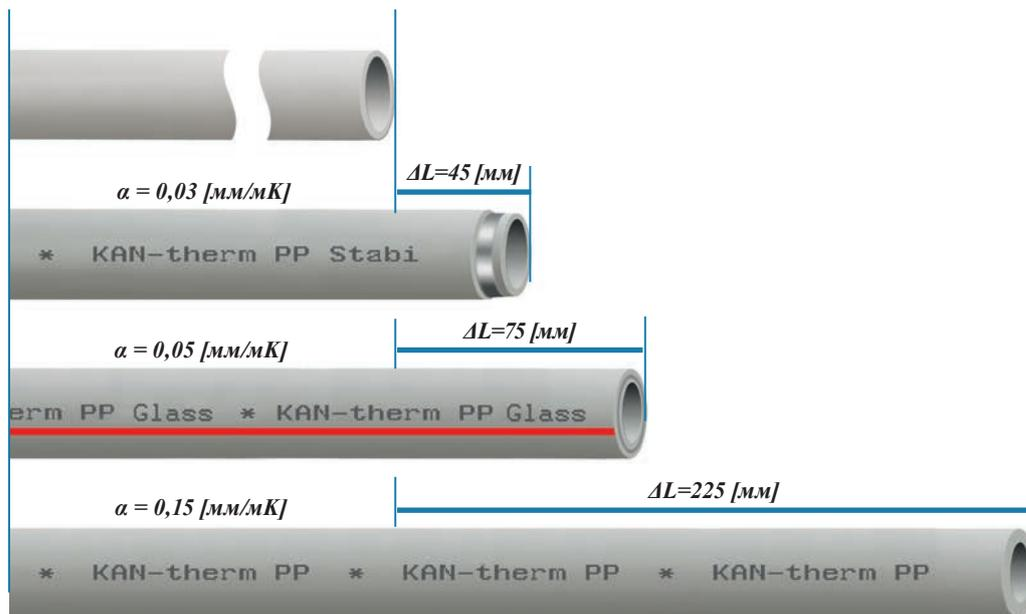
Сравнение теплового удлинения однородных и комбинированных труб Stabi Al и Glass Системы KAN-therm PP.
