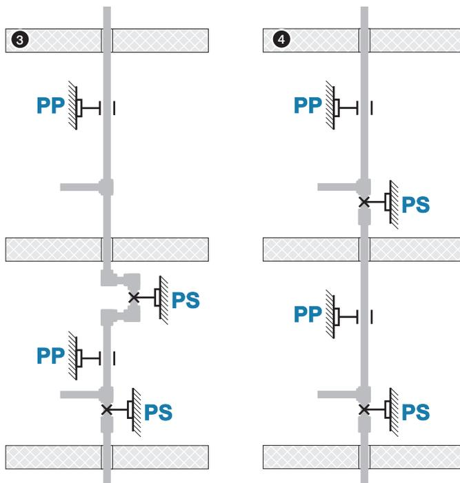
Максимальное расстояние между подвижными опорами для однородных труб Системы KAN-therm PP в зависимости от диаметра и температуры воды. Для вертикальных участков трубопровода расстояние между опорами можно увеличить на 30 %.
