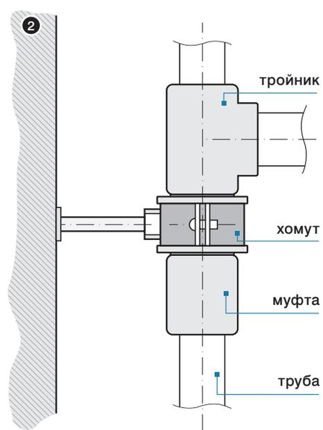
Примеры прокладки стояков системы горячего водоснабжения в зависимости от вида труб (рис. 3 и 4), где: PP - подвижная опора, PS - точка неподвижной опоры
