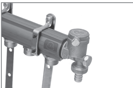
Распределитель с тройником с автоматическим воздуховыпускным клапаном и спускным вентилем (R5541)
