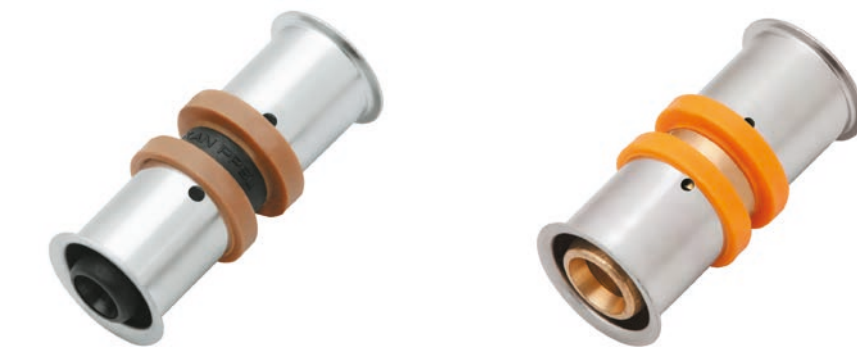
Рис. 50. Двухсторонний соединитель KAN-therm Press LBP для многослойных труб 16 × 2; 20 × 2; 25 × 2,5
