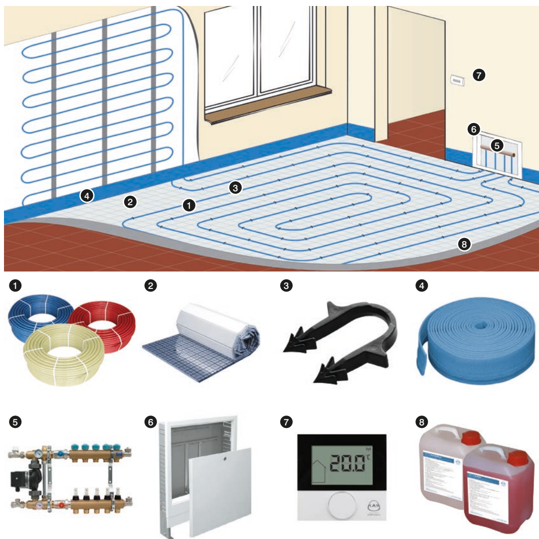
Рис. 46. Элементы панельного отопления/охлаждения KAN-therm
